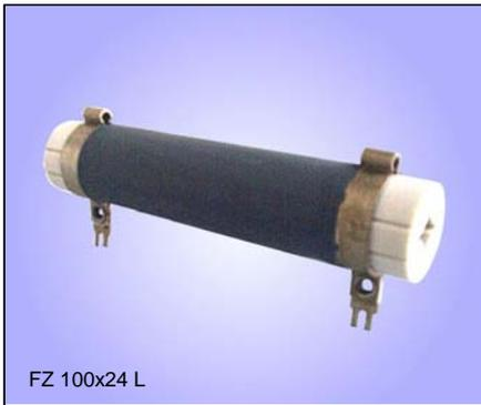
Zementierter drahtgewickelter Rohrfestwiderstand in Schutzart IP00 mit Lötchellen, auch zum Einlöten auf Leiterplatten, Befestigung und Anschluss mittels Lötchellen waagrecht zur Montagefläche. Anschlüsse vorverzinnt.
